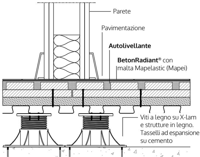
Esempio del passaggio degli impianti sotto il sistema radiante sopraelevato **Betonradiant®**
