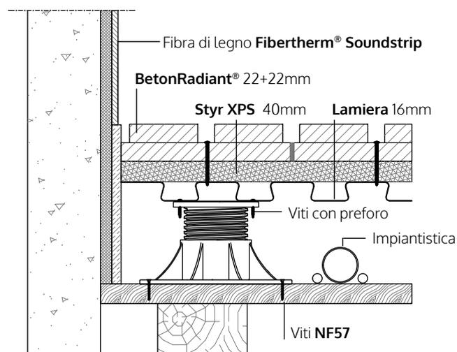
Posizionamento dei supporti regolabili tipo **SE** su sottofondo in legno oppure X-Lam.
