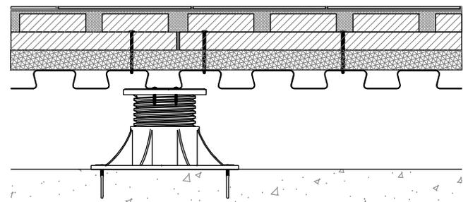
Giunti di dilatazione del sistema radiante **BetonRadiant®**.
