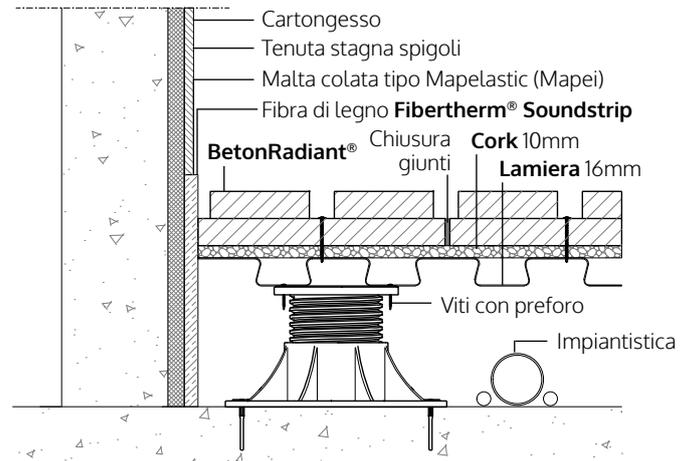
Fissare la base dei supporti regolabili tipo **SE** con viti a legno tipo **NF57** su sottofondo in legno oppure X-Lam; invece, per sottofondi in cemento sono indicati dei tasselli ad espansione
