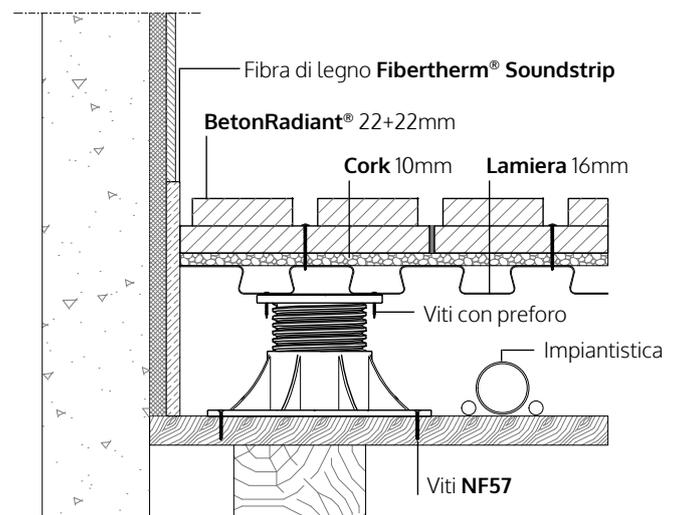
Posizionamento dei supporti regolabili tipo **SE** su sottofondo in legno oppure X-Lam.
