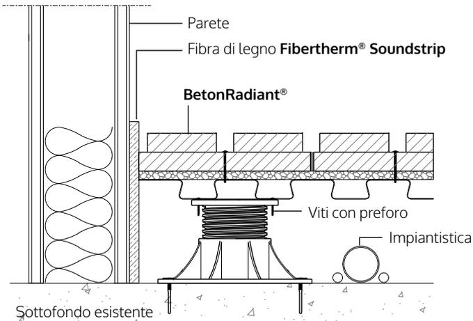
Collegamento con parete tramite strisce isolanti in fibra di legno flessibili **Fibertherm® Soundstrip**
