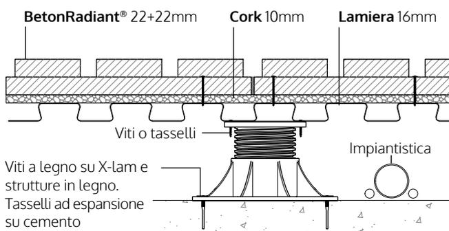
Corretto posizionamento dei supporti con livellamento a laser e fissaggio della testa con viti con preforo.
