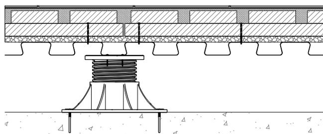
Giunti di dilatazione del sistema radiante **BetonRadiant®**.
